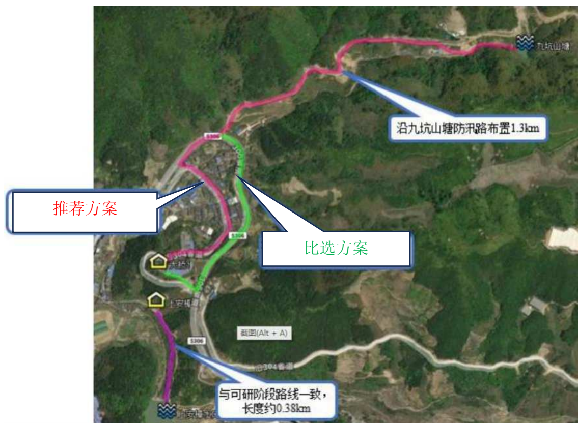
图 4.1-7 大桥分区引水方案比选示意图
