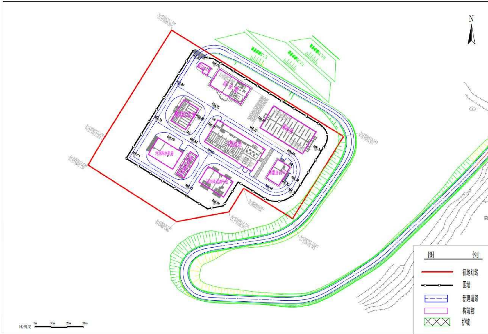
图 3.5-9 平湖水厂平面布置图
