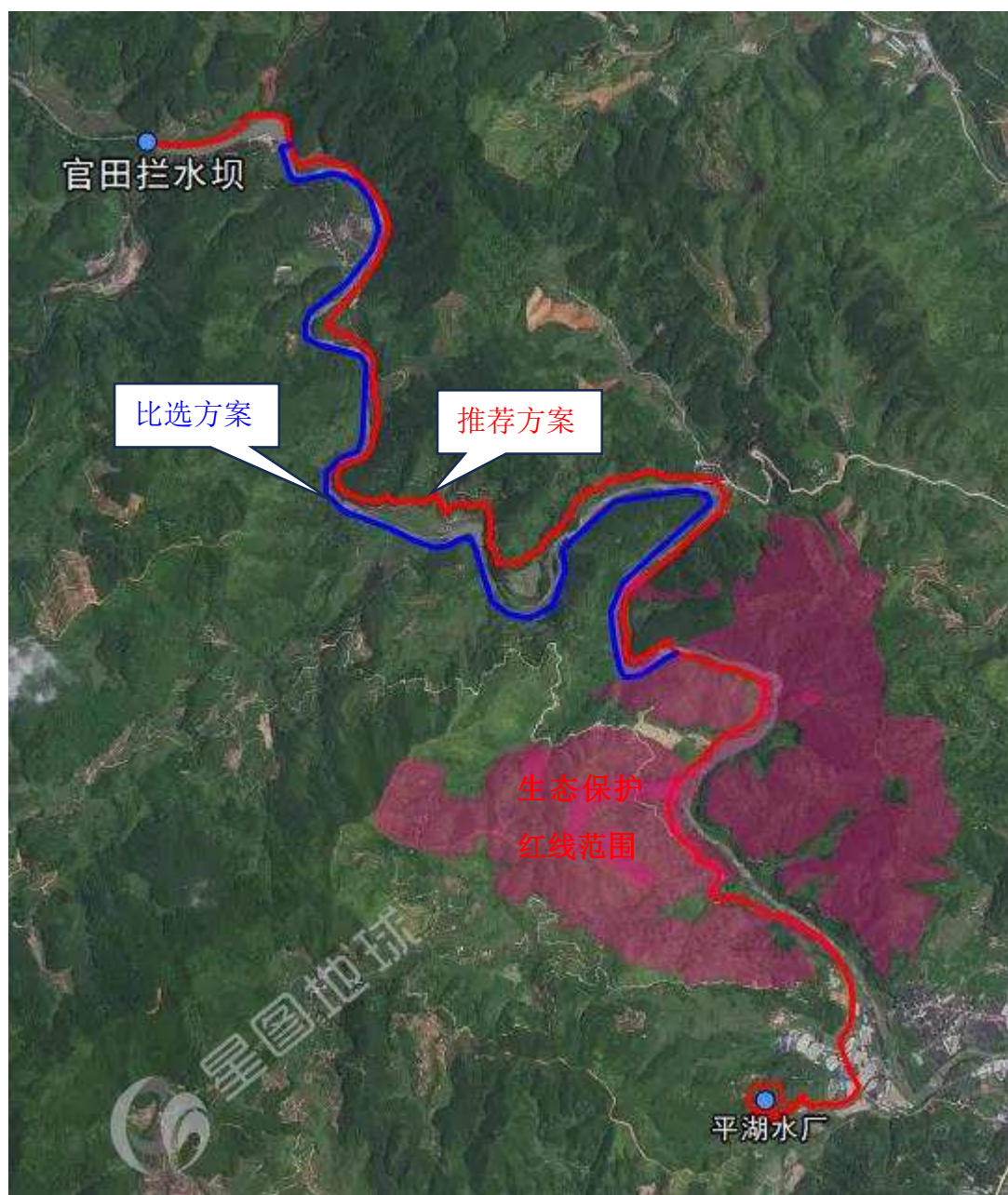
图 4.1-5 平湖-凤埔分区引水方案比选示意图
